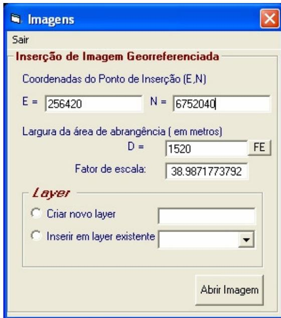
Figura 08. Inserção de Imagem Georreferenciada em desenho ativo
